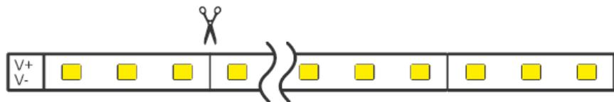
Если необходимо оптимизировать длину ленты, ее можно обрезать. Отрез производится по отметкам на соединительной плате.
